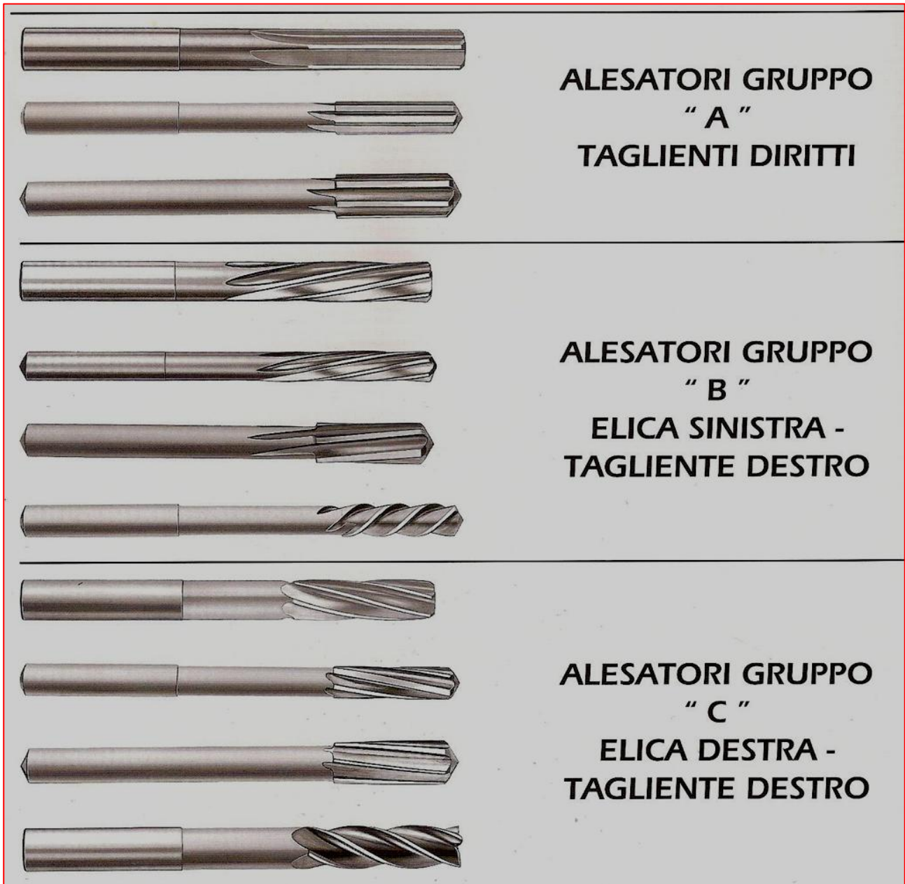
Figura N°2- Vari tipi di alesatori integrali in metallo duro (Cerin – Affi –VR)
